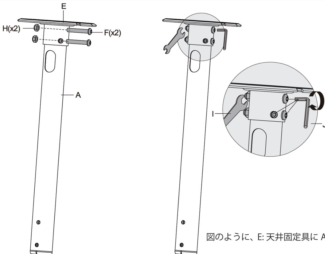
図のように、E:天井固定具にA:支柱を結合します。
