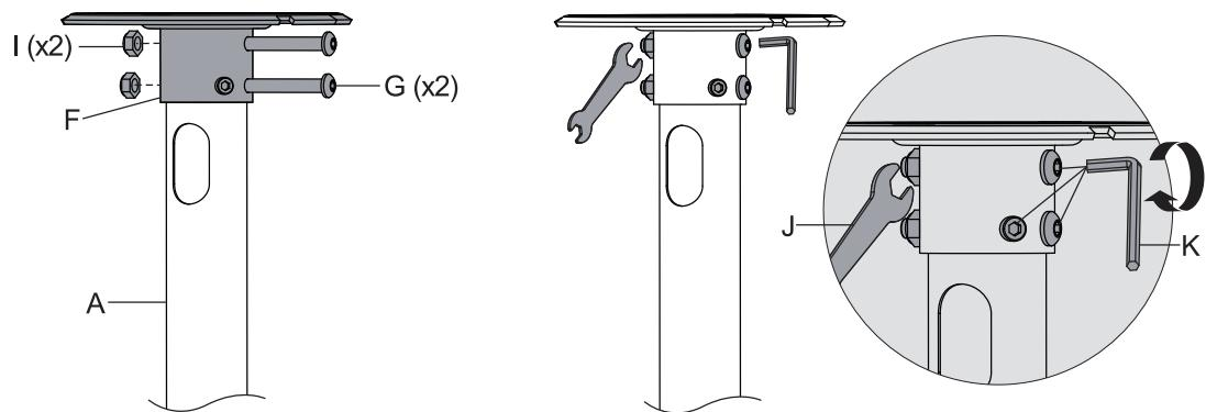
図のように、F: 天井固定具に A: 支柱を結合します。
